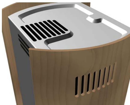
Figur 14. Öppningar för luftgenomströmning.
